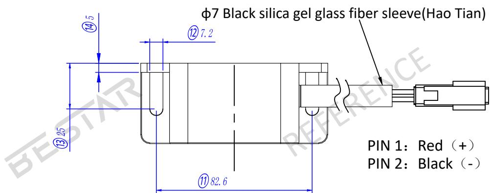
Tolerance: $\pm 0.5\text{mm}$
